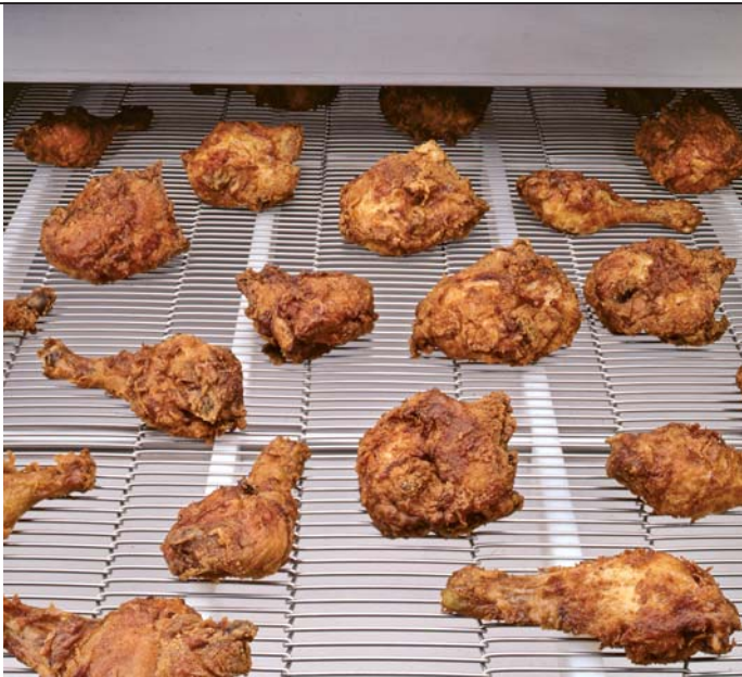
Unsere Drahtfördergurte verfügen über ein offenmaschiges Design zur Verbesserung der Effizienz in Kühl-, Überzugs-, Entwässerungs-, Erhitzungs- und Trocknungsanwendungen.
