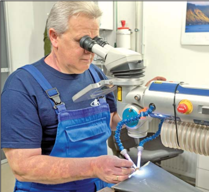
Filigranes Reparaturschweißen von Heißkomponenten durch manuelles Laserdrahtschweißen (LDW)
