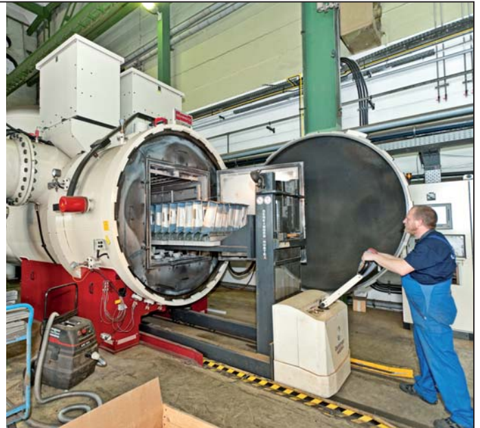
Wärmebehandlung von GT-Hochtemperaturkomponenten im Vakuumofen, optional Vakuum-Härten
