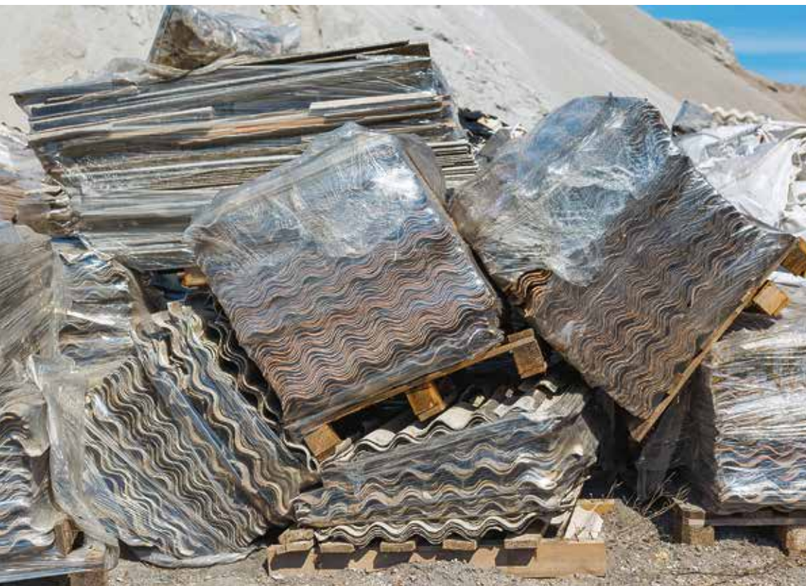
Dachdeckungsmaterial mit Asbestfasern
