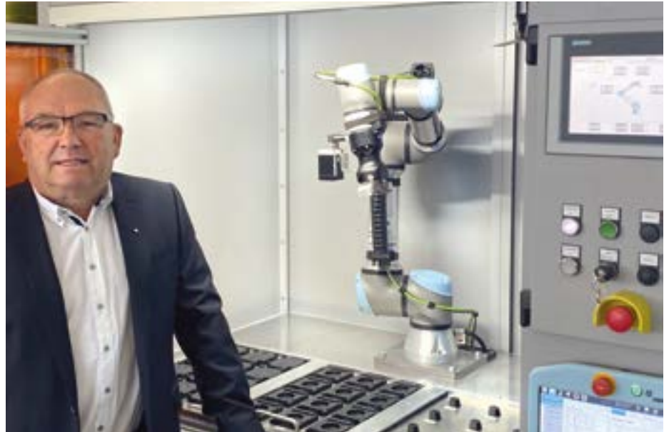
Inhaber Ludwig Stadler vor der aktuellen Universal-Robots-Anlage. Sie dient zum Kleben und Fügen von LED-Strahler-Steuerungsplatinen für einen Film- und Theaterstrahler-Hersteller.
