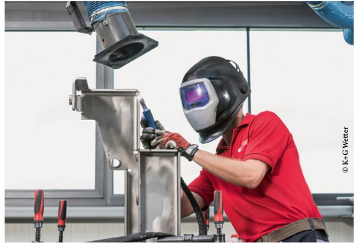
Lasern, Kanten, Schweißen, Fräsen, Schleifen, Montieren: In der eigens für die Fertigung von Edelstahlkomponenten erbauten Halle verwandeln qualifizierte Mitarbeiter bei K+G Wetter einfache Bleche in imposante Maschinengehäuse.
