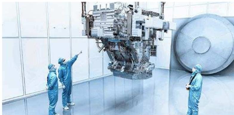
Das Beleuchtungssystem für die High-NA-EUV-Lithographie wiegt rund sechs Tonnen und besteht aus mehr als 25.000 Einzelteilen. Foto: ZEISS
