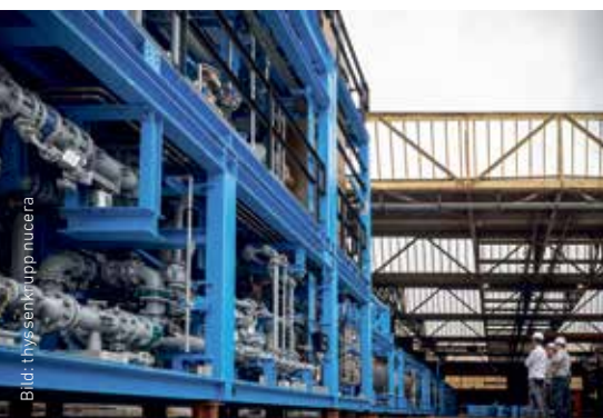
Meilenstein-Projekt: Scalum, ein innovatives Standardmodul für die alkalische Wasserelektrolyse, um grünen Wasserstoff im industriellen Maßstab herstellen zu können.
