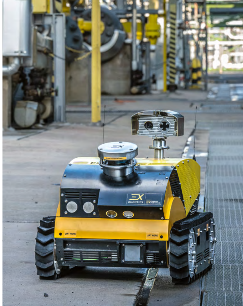
Die Roboterinspektoren von Energy Robotics werden bereits in großen Industrieanlagen eingesetzt. KI-gestützt erkennen sie Anomalien und können Warnmeldungen abgeben. Fotos: Energy Robotics
