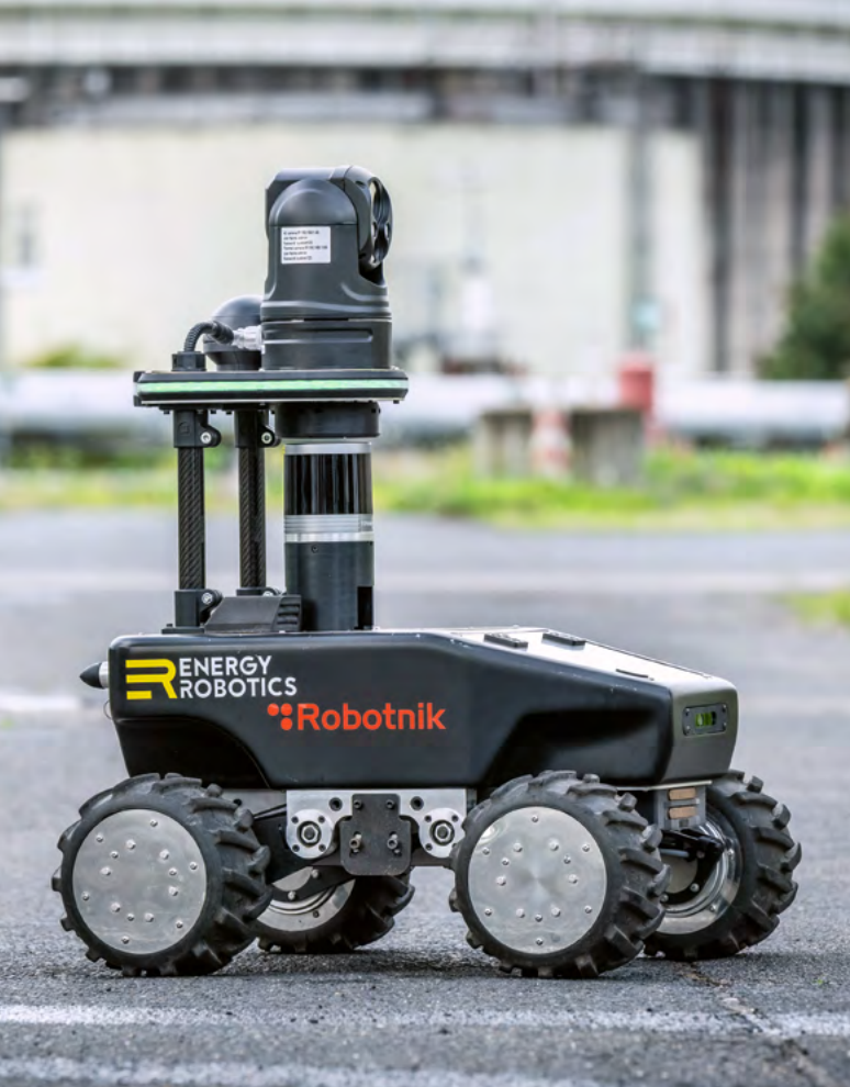
Die Roboterinspektoren von Energy Robotics werden bereits in großen Industrieanlagen eingesetzt. KI-gestützt erkennen sie Anomalien und können Warnmeldungen abgeben. Fotos: Energy Robotics
