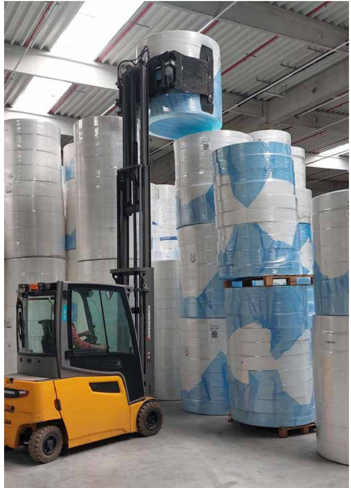
Im Lager, das 12.000 m 2 umfasst, kommen auch Gabelstapler mit Ballenzange zum Einsatz.
