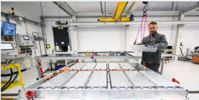
Ein Mitarbeiter entnimmt ein Batteriemodul aus einer ausgedienten Batterie eines Elektroautos. Foto: Julian Stratenschulte dpa
