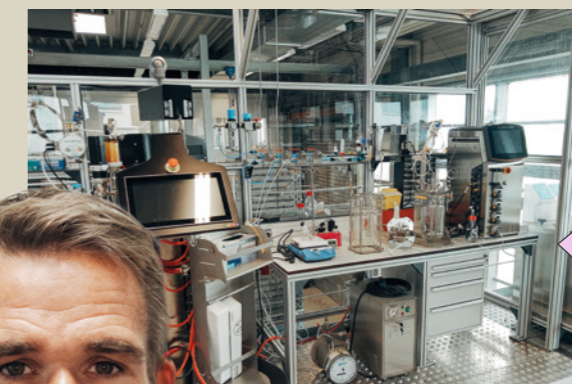
Biofermenter für die Produktion von Basischemikalien für biobasierte Kunststoffe.
