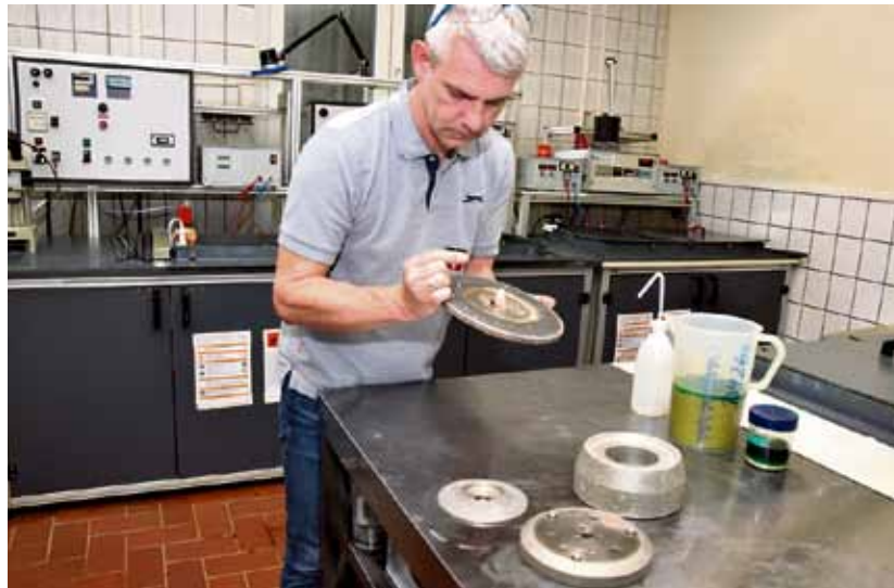
Ralf Niebuhr kontrolliert die ordnungsgemäße Beschichtung einer Schleifscheibe zur Endbearbeitung von Federn. Foto: IHK / K. Buschmann
