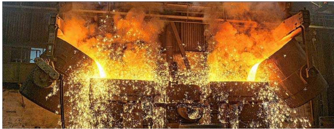
Abguss einer Kalenderwalze in Königsbronn bei HWK. Foto: HWK
