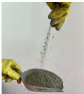
Aus Filterstäuben und Aschen aus der Kohleverstromung stellt EcoMent seinen CO 2 -freien Zement her.
