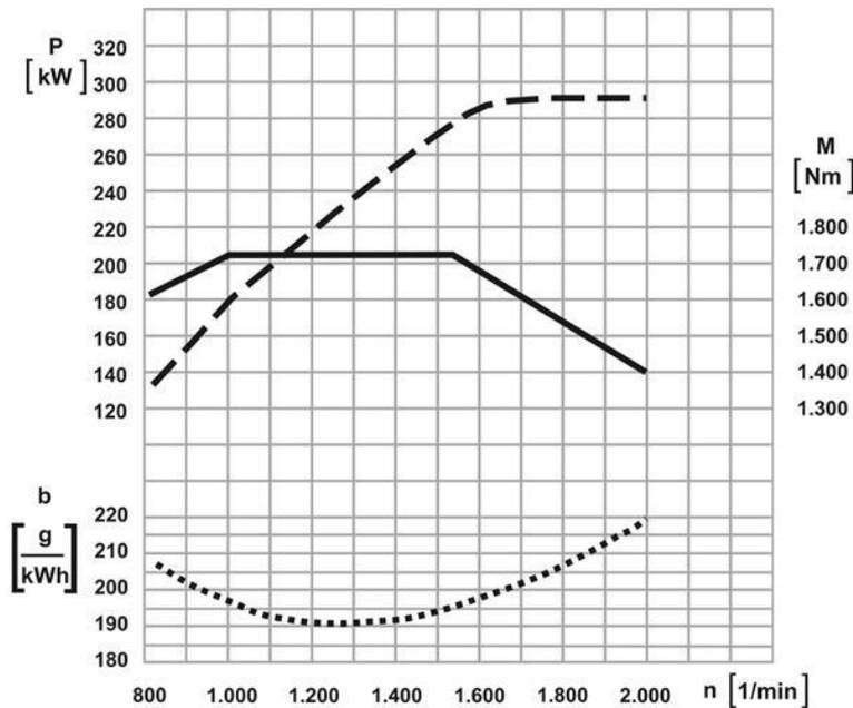
**15 Das Diagramm zeigt die Verbrauchskennlinie eines Motors.**
