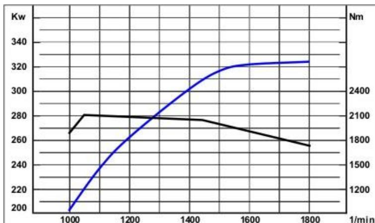
347 Die Abbildung zeigt die Volllastkurven eines Dieselmotors.
