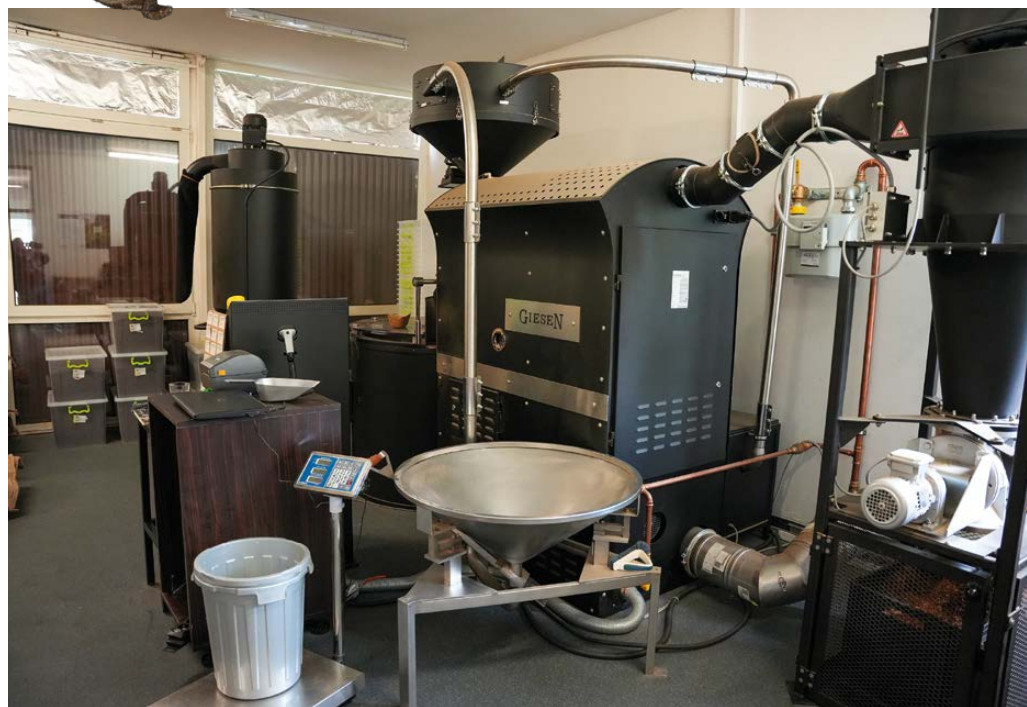
Die Röstmaschine röstet in etwa 20 Minuten 30 Kilogramm Kaffeebohnen. Insgesamt können etwa 1.400 Kilogramm pro Tag geröstet werden.
