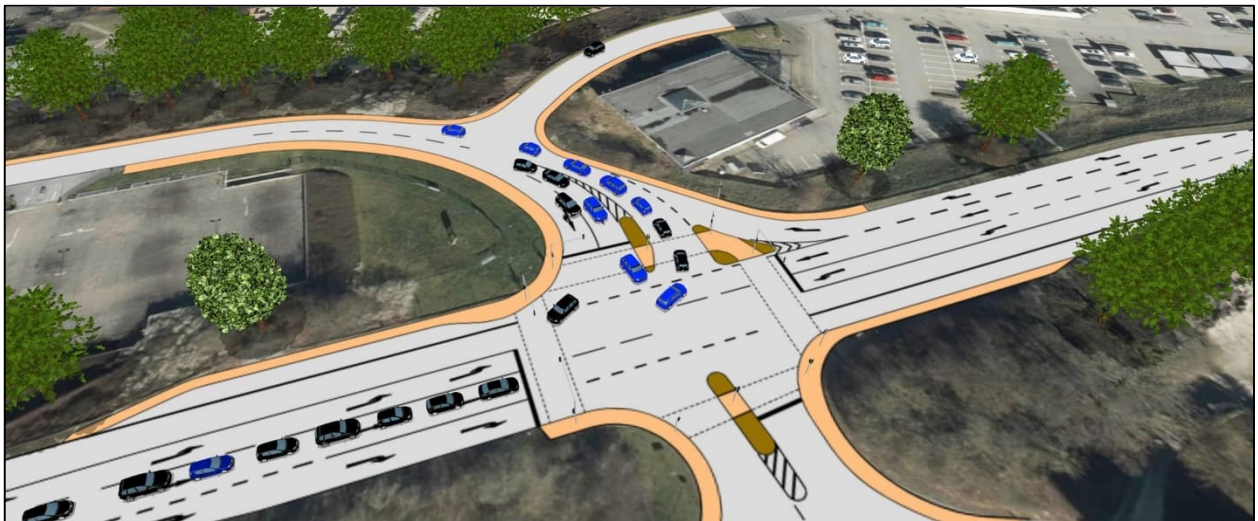
Abbildung 12: Entstehung eines Rückstaus in Richtung KP 2 im Prognose-Planfall im Bestand (Rechts-vor-Links an KP 3)
