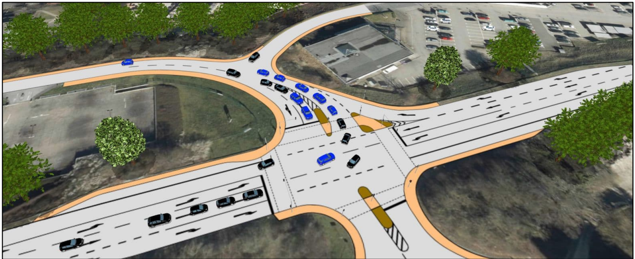
Abbildung 11: Entstehung eines Rückstaus in Richtung KP 2 im Prognose-Planfall im Bestand (Rechts-vor-Links an KP 3)
