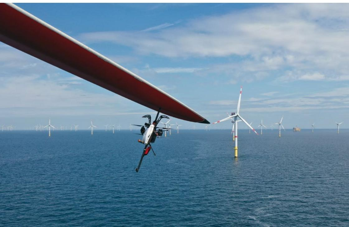
Eine Drohne dockt an ein Rotorblatt einer Offshore-Windkraftanlage an.
