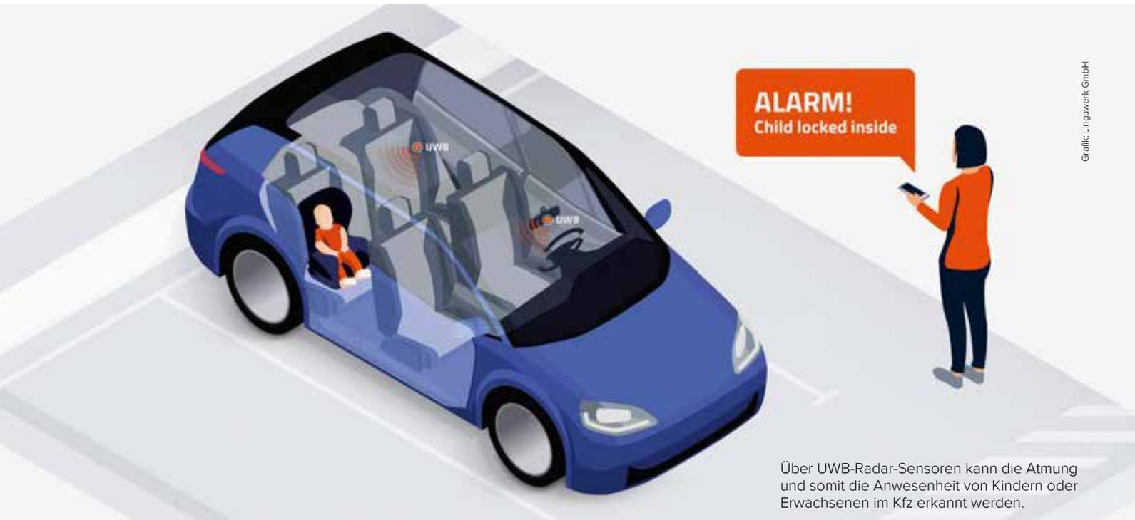
Über UWB-Radar-Sensoren kann die Atmung und somit die Anwesenheit von Kindern oder Erwachsenen im Kfz erkannt werden.
