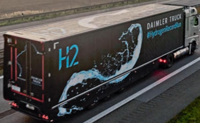
*Gelungenes Experiment: Der Truck hat mit einer Tankfüllung flüssigem Wasserstoff die 1.000-Kilometer-Marke erreicht*
