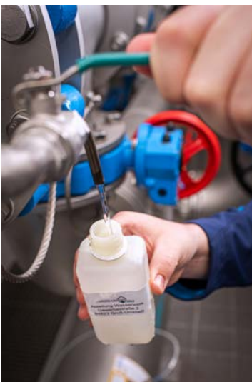
Abbildung 11: Mikrobiologische Probenahme (Quelle: Stadt Groß-Umstadt)
