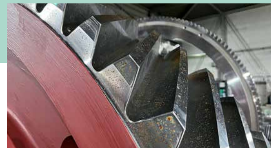
Tonnenschwere Teile wie Zahnräder werden hier gehärtet.
