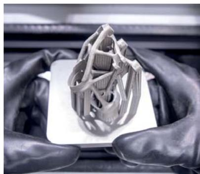
Lenkradaufhängung eines Autos von CAT-Racing für die Formular Student
