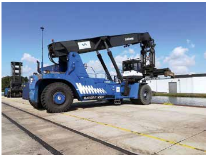
Einsatz auf einem Hafengelände: ein sogenannter Barge Stacker
