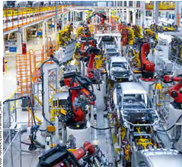
Vollautomatisierte Prozesse in der Automobilindustrie: Roboterarme schweißen am Fließband an Karosserien
