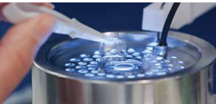
Messung einer Kontaktlinse mit einem Ultraschallmessgerät
