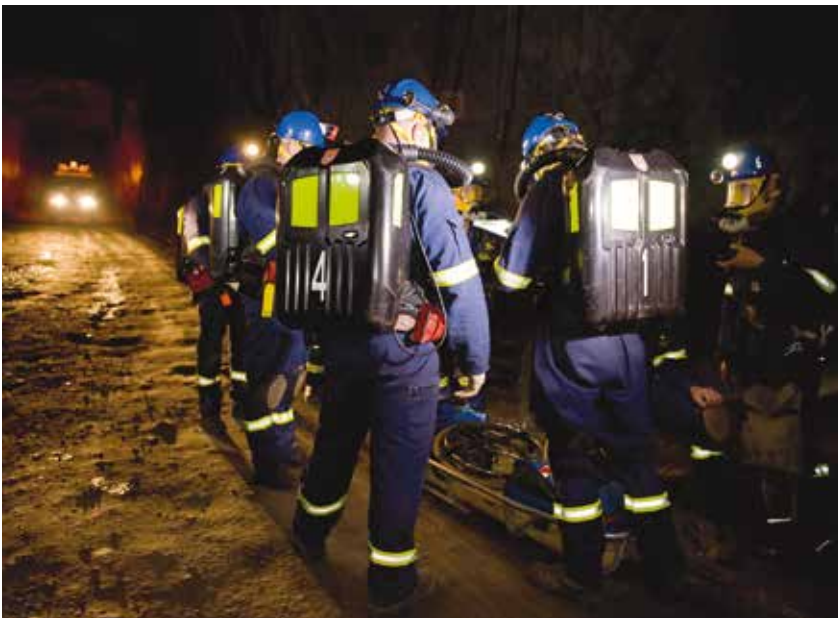
Kreislauf-Atemschutzgeräte Dräger PSS BG 4 plus im Einsatz
