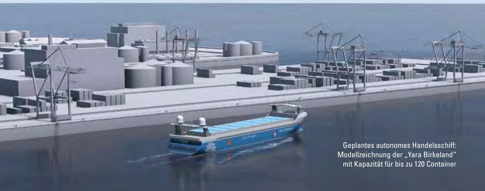
Geplantes autonomes Handelsschiff: Modellzeichnung der „Yara Birkeland“ mit Kapazität für bis zu 120 Container
