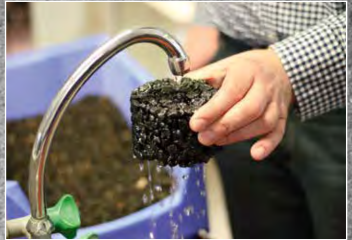
Links oben: In der Raffinerie in Heide wird Bitumen aus Rohöl gewonnen; rechts oben: Gesteine mit unterschiedlichen Körnungen bilden das Ausgangsmaterial von Asphalt; links unten: verschiedene Asphaltarten im SAW-Labor in Schleswig; rechts unten: Drainage-Eigenschaften einer Asphalt-Deckschicht
