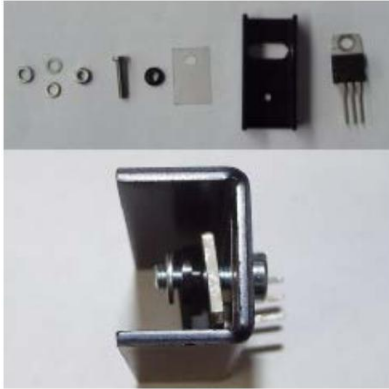
Bild 13: Aufbau des Kühlkörpers
