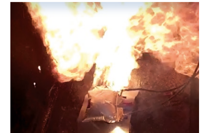
Explosion während eines Thermal Runaway einer Lithium-Ionen-Pouchzelle.
