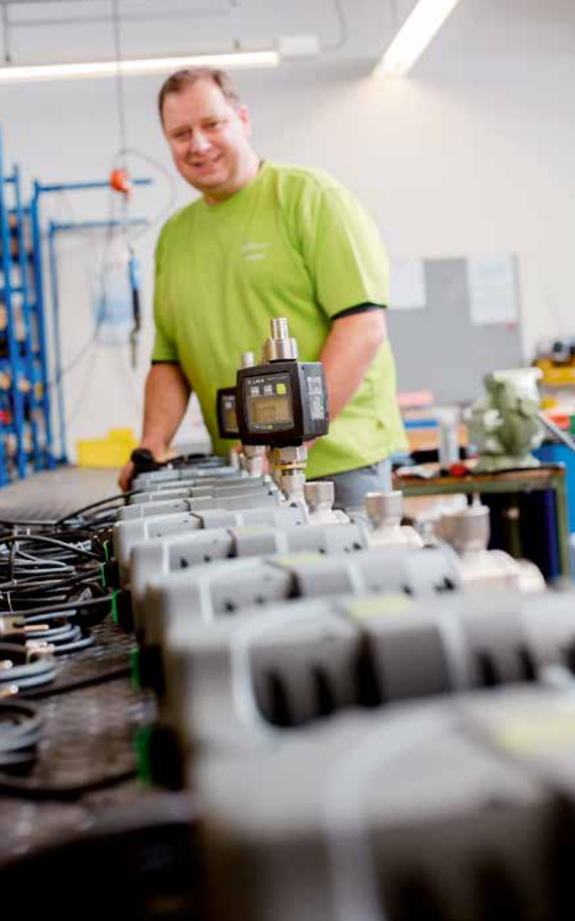
Halten hohem Druck stand: Tecalemit-Durchflussmesser
