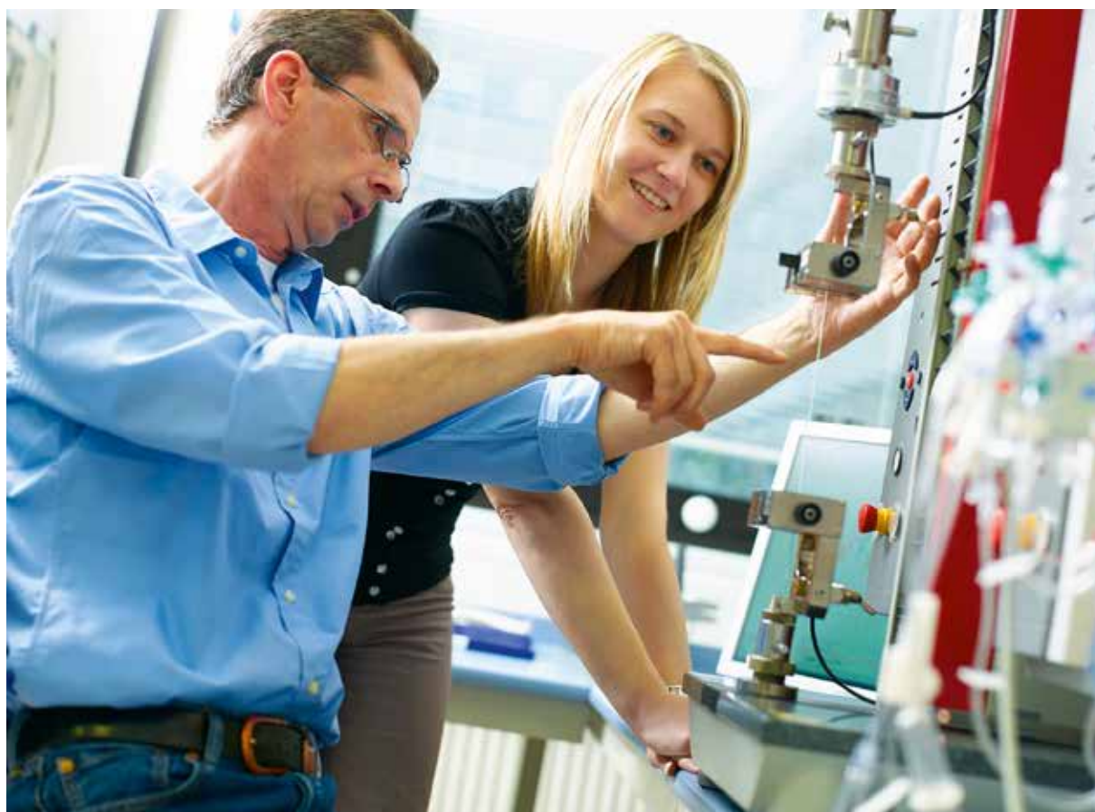
Sparte Medizintechnik: Techniker vermessen die Beschichtung eines Ballonkatheters
