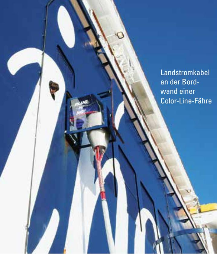
Landstromkabel an der Bordwand einer Color-Line-Fähre
