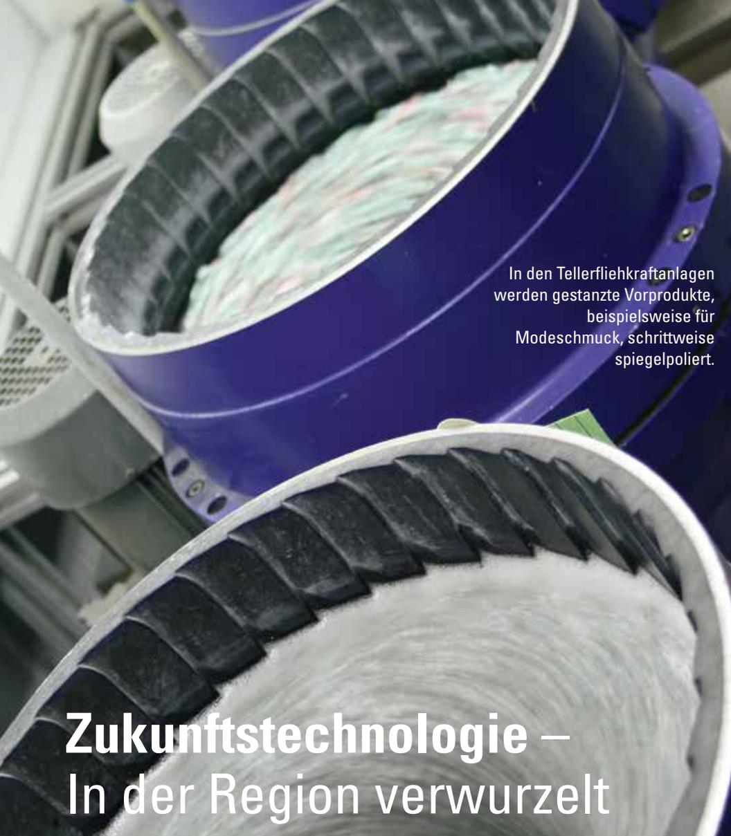
In den Tellerfliehkraftanlagen werden gestanzte Vorprodukte, beispielsweise für Modeschmuck, schrittweise spiegelpoliert.
