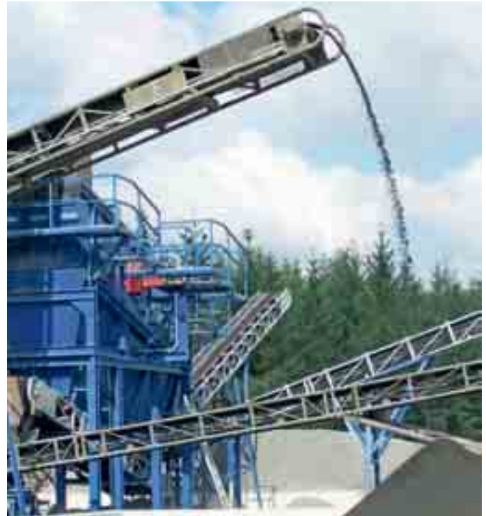
Für den Einsatz im Straßenbau: Schlacke aus dem Elektrolichtbogenofen hat eine besonders hohe Qualität. Das Unternehmen verarbeitet rund 270000 t im Jahr.
