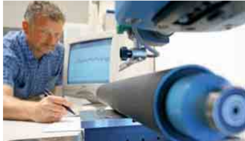
Geschulte Mitarbeiter, hohes Qualitätsniveau: In Melle entstehen hoch präzise Gummiwalzen unter anderem für die Druckindustrie.
